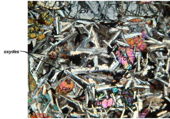
Figure 9. Vue microscopique d'une portion de la dolérite en lumière polarisée et analysée (Pl: plagioclase, Ol : olivine, Cpx : clinopyroxène).
